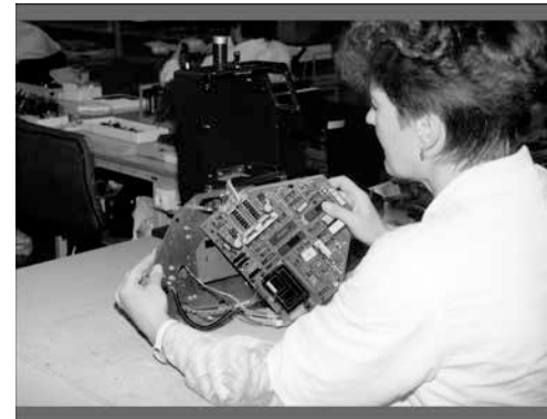
400. Montaż płyty elektroniki kasownika biletów
