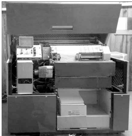
71. Drukarka wierszowa DW-402 w Biurze Informatyki ZME „EMIT” w Żychlinie. Zdjęcie wykonane w 2008 r. Drukarkę wyprodukowano w 1989 r., służyła do 2011 r., nadal sprawna, lecz wycofana z powodu zmiany systemu informatycznego
