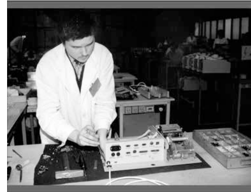
397. Kontrola zwijacza taśmy drukarki fiskalnej
