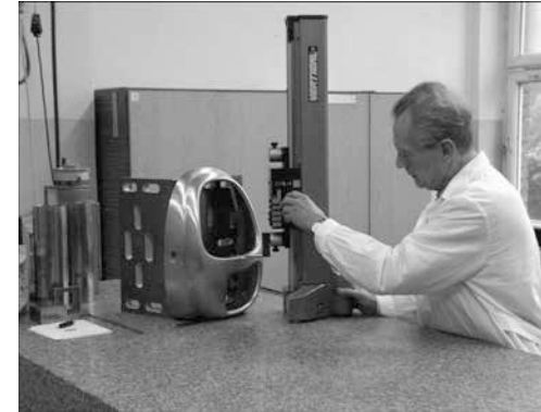
421. Kierownik Izby Pomiarów Stanisław Ciesielski sprawdza obudowę telefonu
