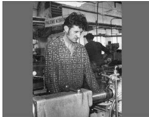
285. Toczenie tulei bębna drukującego
