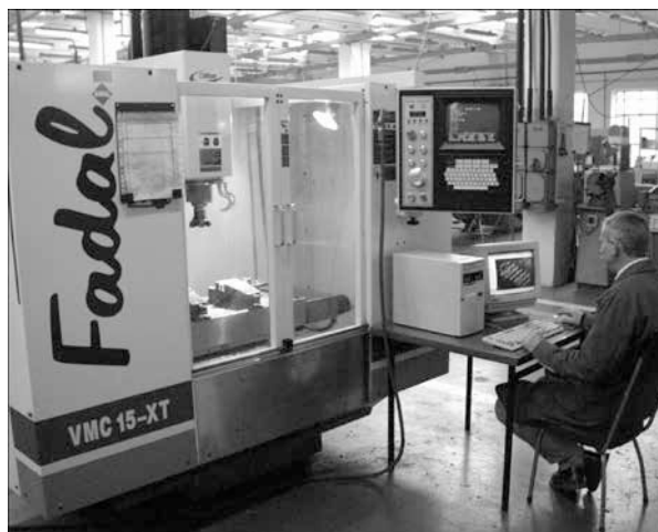
112. Obsługa frezarki sterowanej numerycznie, przy pulpicie mgr inż. Henryk Misiak
