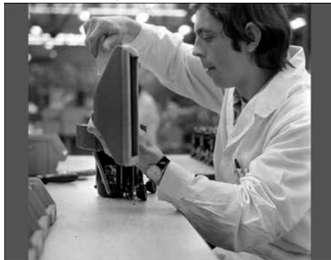
290. Montaż dyfuzora drukarki, Oddział w Siedlcach
