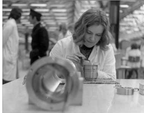
288. Montaż bębna emitera drukarki, Oddział w Siedlcach
