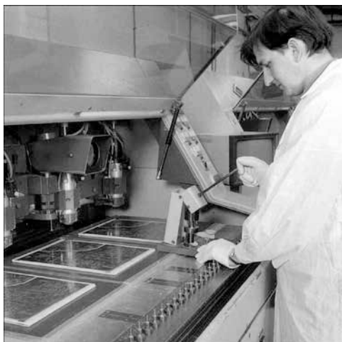
110. Obsługa wiertarki wielowrzecionowej, wiercenie otworów w obwodach drukowanych
