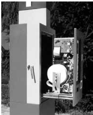
121. Parkometr, mechanizm z elektroniką
