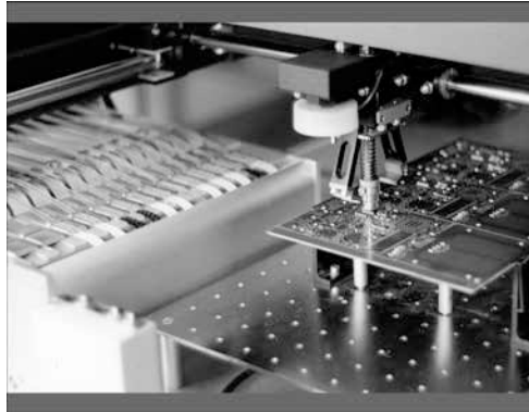
395. Półautomat do montażu powierzchniowego pakietów elektroniki
