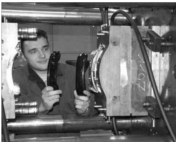
111. Obsługa wtryskarki do tworzyw termoplastycznych, wtrysk elementu słuchawki aparatu telefonicznego
