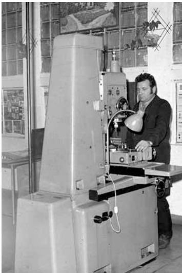
82. Narzędziowiec Ryszard Cieślak pracuje na wytaczarce współrzędnościowej firmy SIP (Szwajcaria)
