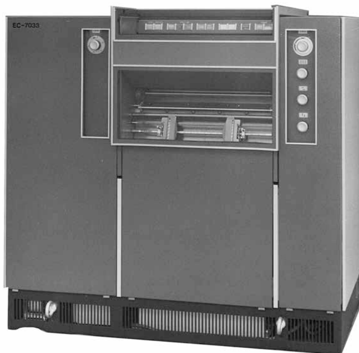
9. Drukarka wierszowa DW-3/EC-7033 o prędkości wydruku 1100 wierszy na minutę, opracowana przez Instytut Maszyn Matematycznych w Warszawie i konstruktorów ZMP „Mera-Błonie”, wytwarzana w latach 1974-1990
