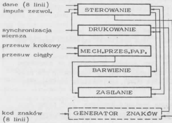
Rys. 9. Schemat blokowy sterowania w drukarce elektrostatycznej
