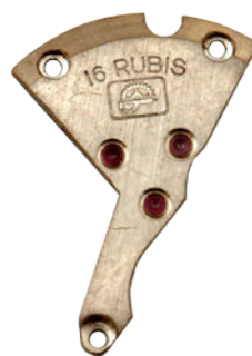
Rys. 8.8. Mechanizm polski i odmiana mostka przekładni chodu
