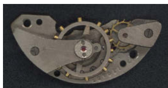
Rys. 16.1. Oryginalna przystawka X-8 produkcji Czystopolskiej Fabryki Zegarków (na zdjęciu bez przesuwki)
