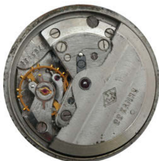
Rys. 8.12. Mechanizm z automatycznym naciągiem
