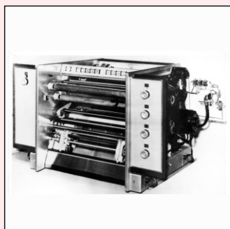
19. Mechanizm 666/V3 szybkiej drukarki wierszowej 1970-1990
